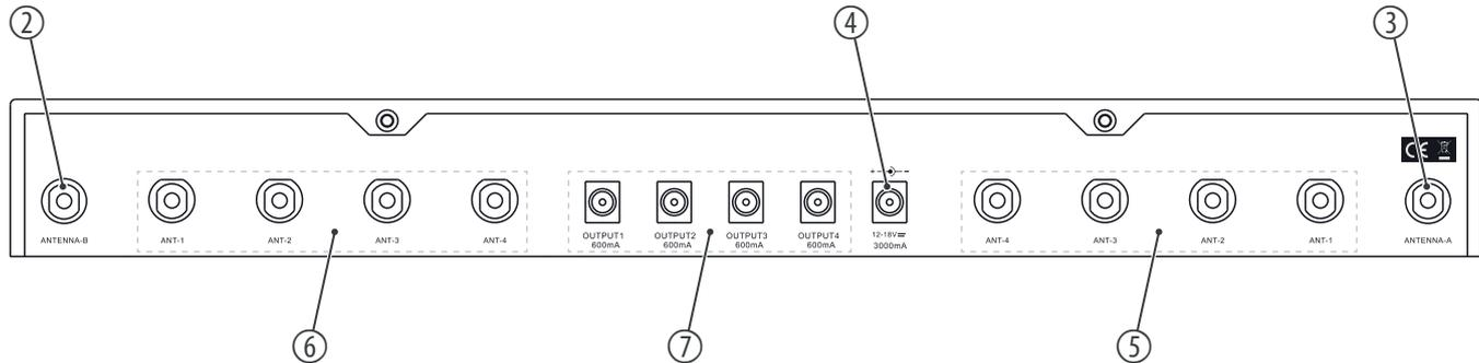
2, 3 [ANTENNA-A], [ANTENNA-B] | BNC-Einbaubuchsen für die Kabelverbindung zu den beiliegenden UHF-Rundstrahlantennen.
